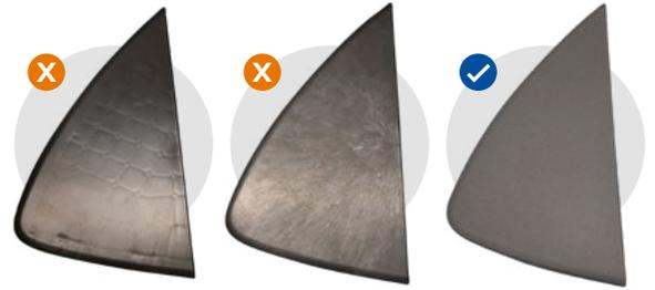
Kompaktspritzguss mit Oberflächenfehlern (z.B. Einfallstellen, Bindenähte etc.)
